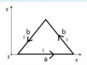
Por el circuito circula una corriente i = 2 A y la espira está inmersa en un campo magnético uniforme **B** = 2T î + 3T k . ¿Cuál es el Momento de las fuerzas o "Torque" (en Nm) actuante sobre la espira ?.
